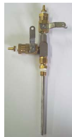
Medidor de Vazão tipo Pitot
